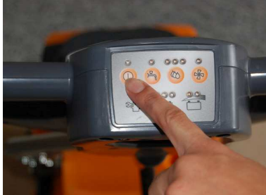
7. Başlatma tuşunu 3 saniye basılı tutun ve makineyi çalıştırın
