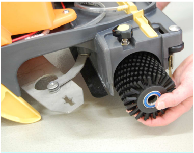
21. Fırça ünitesini çıkarın ve temizleyin
