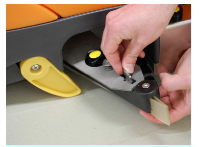
20. Vakum başlığını çıkarın ve temizleyin
