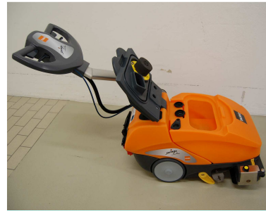
24. Makineyi havalandırması için kapağı açık ve park pozisyonunda bırakın
