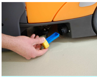
18. Solüsyon tankını boşaltın ve çözelti filtresini temizleyin
