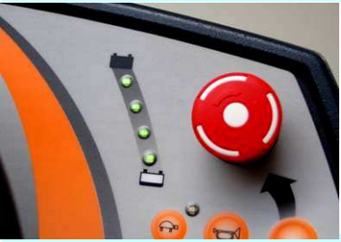
16. Yeşil ışıklar şarj seviyesini göstermektedir. Eğer kırmızı ışık yanarsa kullanım için 10dk kaldığı anlamına gelmektedir.
