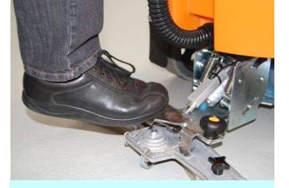
5. Vakum başlığını bağlayın: Ceplerini vakum başlığı tutacağına ön kısmına gelecek şekilde yerleştirin ve tutacağı aşağı itin
