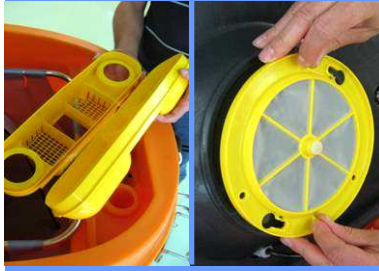
22. Atık filtresini çıkarın. Şamandıra ünitesini (filter ve şamandıra) saat yönü tersinde çevirerek çıkarın
