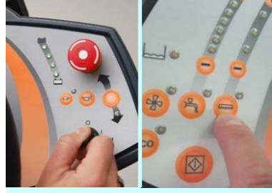
8. Anahtarı saat yönünde çevirerek makineyi başlatın. Fırça düğmesine basarak fırçayı ünite ile birleştirin tekrar basarak üniteyi kaldırın
