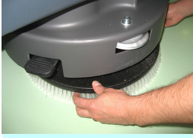
7. Fırçayı dikkatlice kaldırdığınız fırça ünitesinin altına takın
