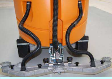
6. Emme hortumlarını takın: Hortumları makinenin merkezine doğru bükün ve vakum başlığına bağlayın
