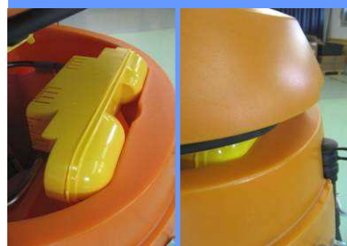
28. Atık filtresini ters çevirin ve tank kapağı açık halde makineyi bırakın (tank kapağı filtre üzerinde)
