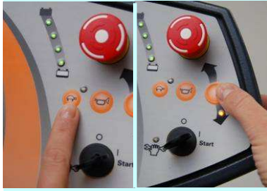
12. Düşük hız düğmesine basarak sürüş hızını yarıya indirebilirsiniz. Geri sürüş düğmesi ile sürüş yönünü geriye çevirebilirsiniz.
