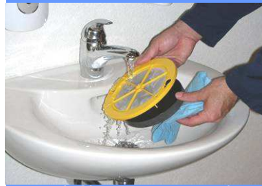
23. Atık filtresini ve şamandıra ünitesini akan su altında temizleyin ve hava ile temas halinde kurumaya bırakın
