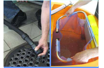
20. Atık tankını ve sonrasında solüsyon tankını boşaltın ve ikisini de temiz su ile yıkayın
