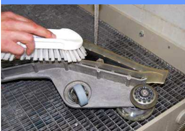
26. Vakum başlığını akan su ile temizleyin ve hava ile temas halinde kurumaya bırakın
