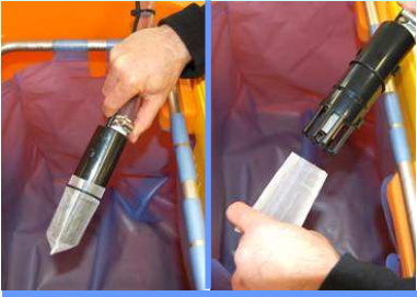
21. Filtre eleğini su pompasından ayırın ve akan su altında temizleyin
